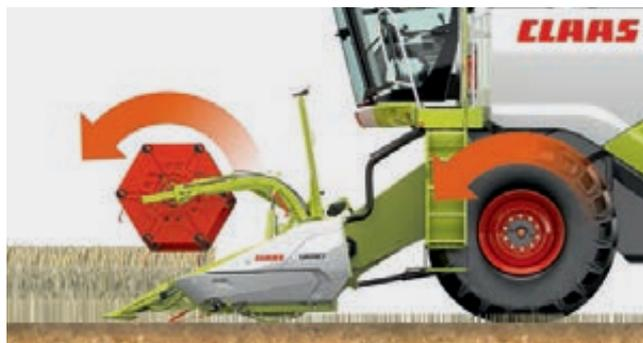
Сравнение фактического состояния с заданными значениями позволяет AUTO CONTOUR адаптировать жатку к рельефу, что обеспечивает существенное облегчение труда, в особенности при использовании жаток с большой шириной захвата, а также ночью, на склонах и каменистой почве. AUTO CONTOUR увеличит производительность и сделает работу с TUCANO еще более экономичной.
