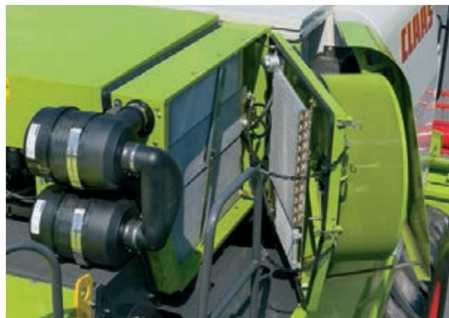
Увеличенная система охлаждения с автоматическим отсосом пыли.
