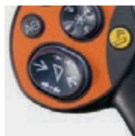
Кнопка регулировки высоты на многофункциональном джойстике позволяет с легкостью включить автоматику жатки.
