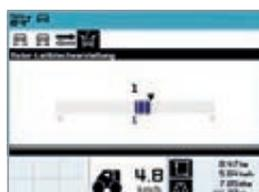
Регулировка направляющего щитка ротора CEBIS
