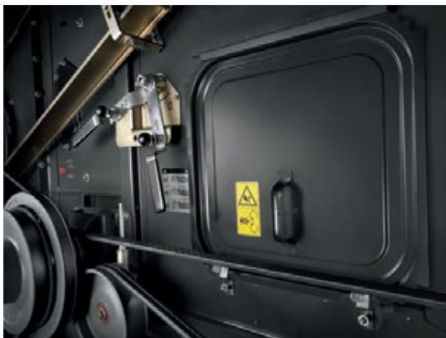
**НОВИНКА:** вариатор ротора для бесступенчатой регулировки частоты вращения.
