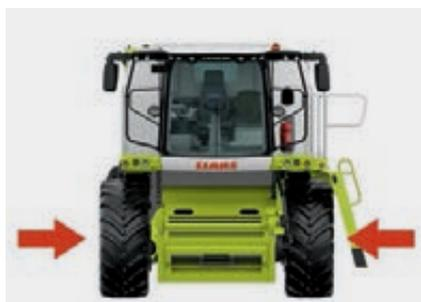
Сниженная транспортная ширина при увеличенной опорной поверхности
