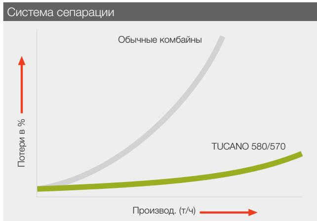
Начиная с определенного уровня производительности, потери при использовании обычных комбайнов резко повышаются, т. к. в данном случае система сепарации зерна выступает в качестве ограничивающего фактора. TUCANO благодаря ROTO PLUS обеспечивает эффективную сепарацию зерна с сохранением допустимого показателя потерь.
