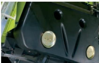
Топливный бак объемом до 650 л.
